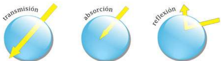
Figura 1. Diferentes tipos de interacción de la luz con los materiales.
