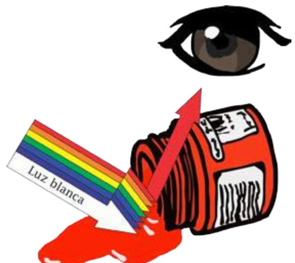
Figura 5. La pintura se irradia con luz blanca y la luz roja no es absorbida por esta, sólo reflejada. ngitudes de onda de la luz visible.
