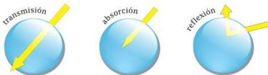
Figura 1. Diferentes tipos de interacción de la luz con los materiales.
