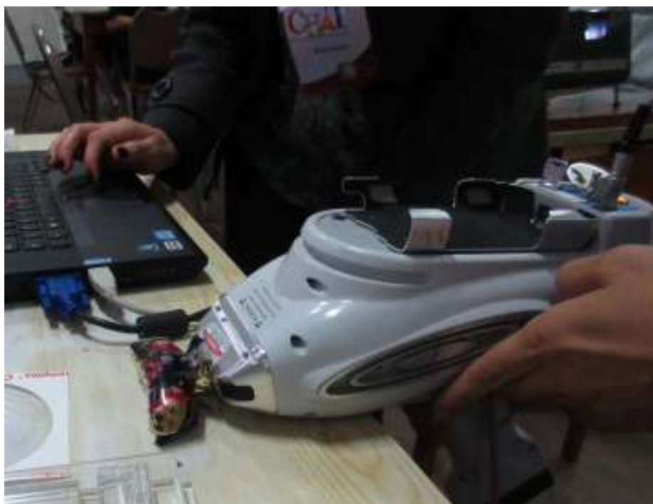
Detalle del analizador de FRX en el taller "Lo que los rayos X nos pueden contar sobre los pigmentos. Pigmentos a lo largo del tiempo" en la iglesia San Pedro de Lima (junio, 2015).
