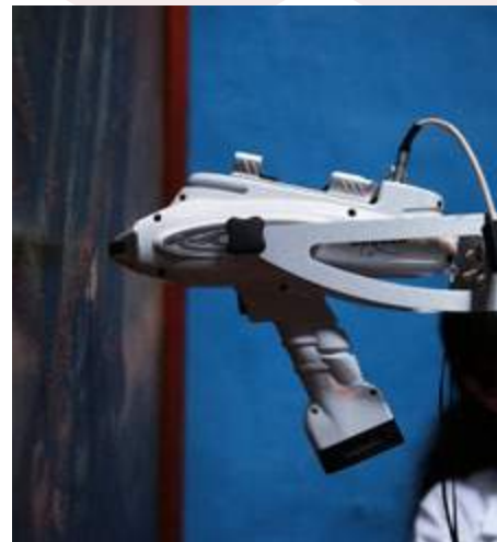
Detalle del analizador portátil de espectrometría de rayos X antes de analizar un lienzo de la pinacoteca del Museo de los Descalzos.
