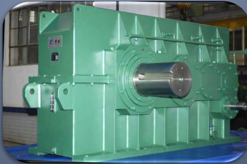
Desarrollo de un sistema inteligente de diseño mecánico para mejorar la competitividad de la empresa metalmecánica nacional aplicado a cajas reductoras de engranajes cilíndricos con carcasa soldada de uso en la industria minera
