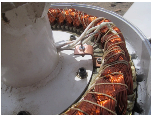
Figura 2: VISTA POSTERIOR DEL GENERADOR DE IMANES PERMANENTES
