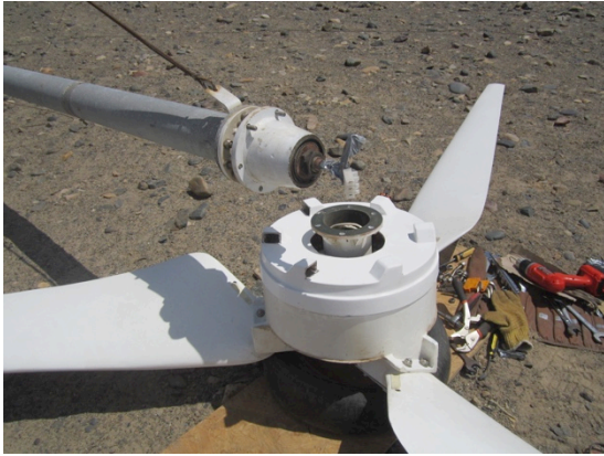
Figura 3: TORRE PIVOTANTE A NIVEL DEL PISO PARA ACOPLARSE AL CABEZAL
