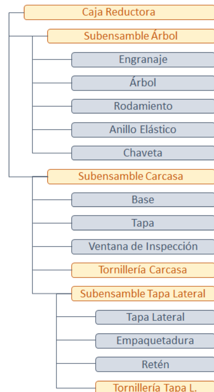
Figura 2: Estructura de objetos de aiGearboxDesigner .
