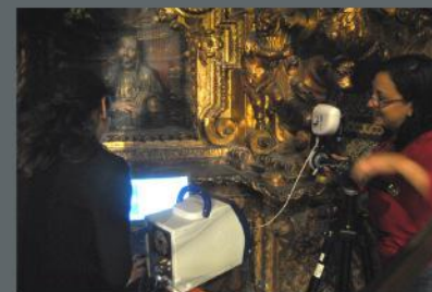
Exámenes del retablo de San Francisco de Borja con un equipo portátil de espectroscopía Raman de la Pontificia Universidad Católica del Perú.
