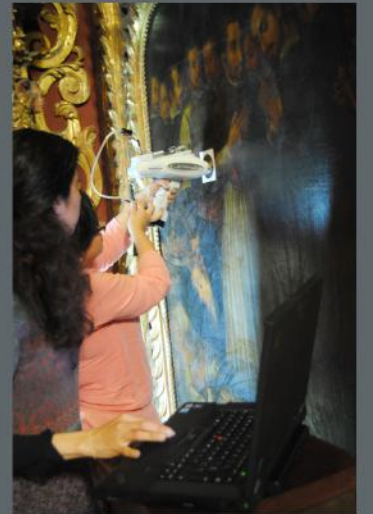
Análisis de un lienzo de la capilla de San Francisco de Borja con un equipo portátil de FRX de la Sección Química de la Pontificia Universidad Católica del Perú.
