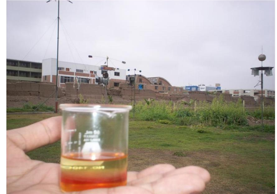
Primer producto de los ensayos en laboratorio de la PUCP, en el vaso se observa encima biodiesel y debajo la glicerina
